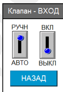
Рисунок 4.6. Окно ручного управления клапаном возврата на входе гомогенизатора
