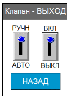
Рисунок 4.7. Окно ручного управления клапаном возврата на выходе гомогенизатора
